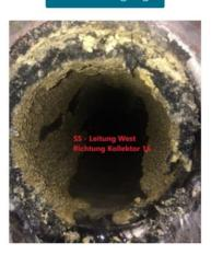
Das Ergebnis zeigt: Der Belag konnte zwar in keinem Leitungsabschnitt gänzlich entfernt werden, jedoch konnten bei wöchentlicher Spülung geringere Belagsdicken erreicht werden. Die Leitung mit 14-tägiger Spülung weist deutlich größere Ablagerungsdicken auf.
